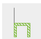
TELAIO Tondino in acciaio cromato diametro 11 con o senza braccioli incorporati. Piedini in nylon
