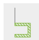
TELAIO (SL) Tondino in acciaio cromato diametro 11, con o senza braccioli incorporati. Piedini in nylon
