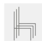
TELAIO (4P) Tubo d'acciaio cromato diametro 18mm spessore 1,4mm con o senza braccioli integrati. Piedini in nylon antiscivolo
